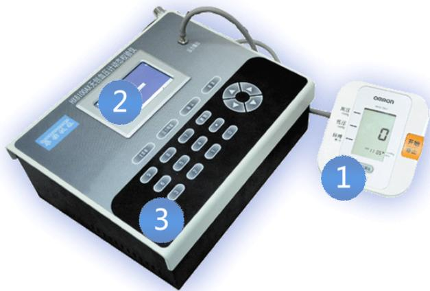
第一步：连接电源，将被检血压计连接到输出口上，打开电源。
