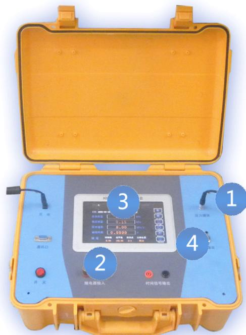
第一步：将压力模块连与被检仪表连接到压力输入和输出口（1）上。
